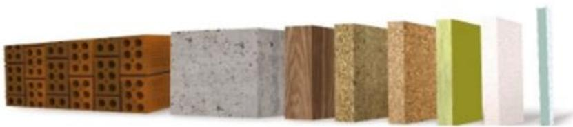
Figura 1.3 Espesor de materiales para el mismo aislamiento.
