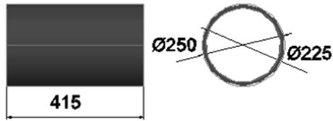
Rolo de Polietileno PE 100 (Densidad 965 kg/m<sup>3</sup>; Resistencia 35 MPa)
