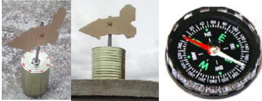
*Figura 2.8 Instrumentos para medir la dirección del viento*
