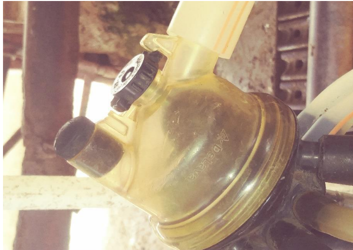
Figura 2.9 Colector. (Fuente propia).
