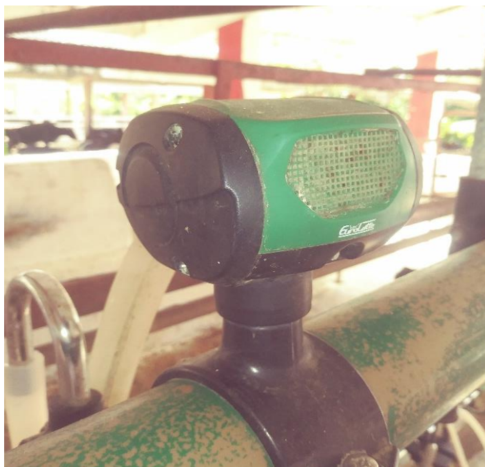
Figura 2.6 Pulsador neumático. (Fuente propia).
