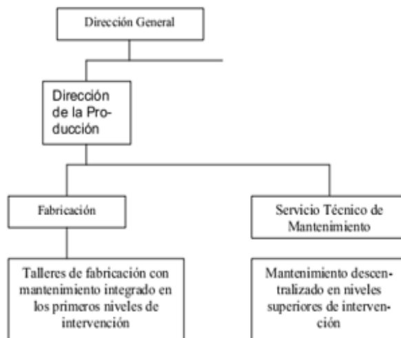
Figura 1.5 Mantenimiento integrado en producción.
