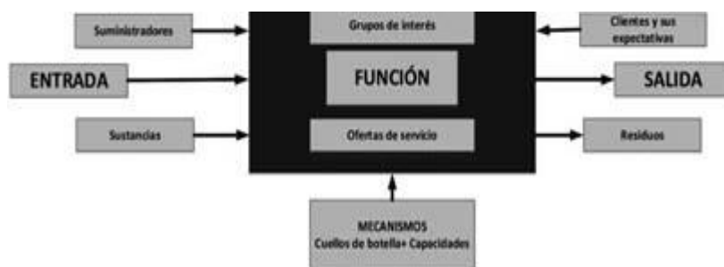
Figura 2.3 Representación general del proceso en aproximación a un IDEFo, fertilizados con otras exigencias normativas
