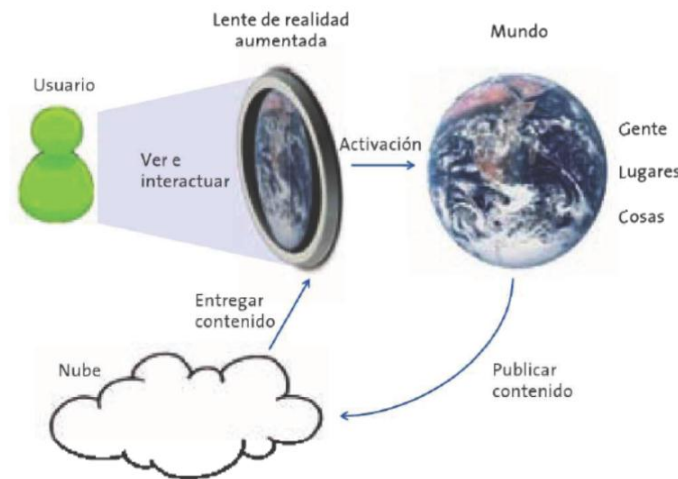
Figura 1.6: Esquema del funcionamiento de un sistema de realidad aumentada. Fuente: (Telefónica, 2011).
