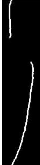
En esta etapa del algoritmo, es posible convertir los píxeles centrales en datos que representan el haz láser, creando así, un perfil del láser que puede ser usado como una función representativa. La figura 24 muestra cómo quedaría la función si se graficase.
