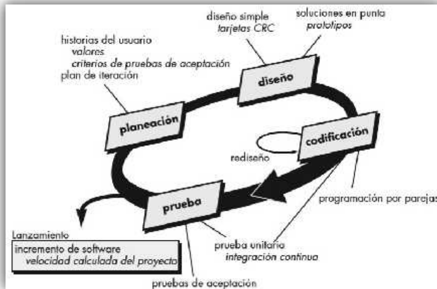
Ilustración 1.1 Proceso de Programación Extrema (Pressman, 2010)
