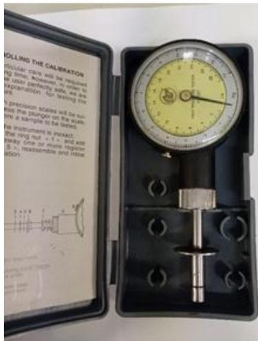
Figura 2. Penetrómetro manual EFFEGI (modelo FT 327, Italia)
