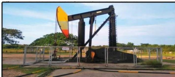
**Figura 1.3 Unidad de Bombeo Balanceadas por Aire. Fuente: (Orjuela & Vanegas, 2019)**
