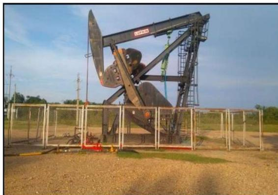
**Figura 1.2 Unidad de Bombeo de geometría especial Mark II. Fuente: (Orjuela & Vanegas, 2019)**
