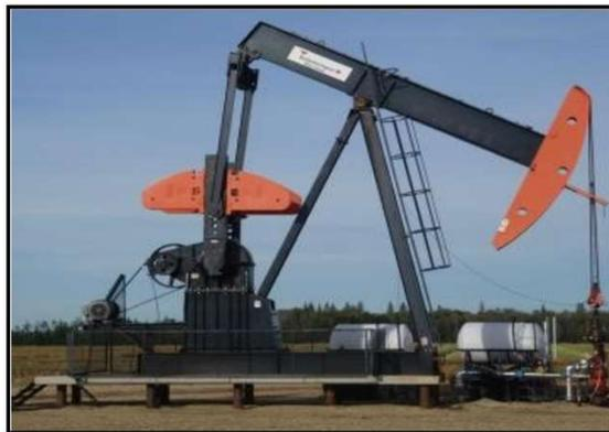
**Figura 1.1 Unidad Convencional de bombeo mecánico. Fuente: (Orjuela & Vanegas, 2019)**
