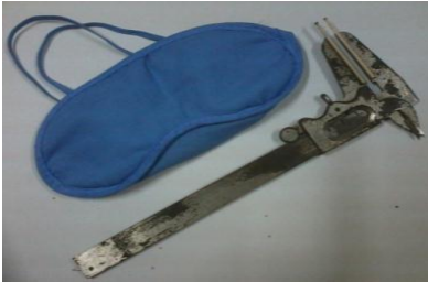
Figura 3.1: Pie de rey (instrumento utilizado para medir Umbral de Discriminación Táctil).
