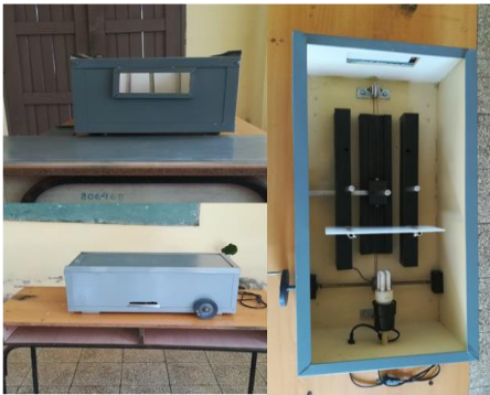
Figura 3.2: Caja de Gover (instrumento utilizado para medir Percepción de Profundidad).
