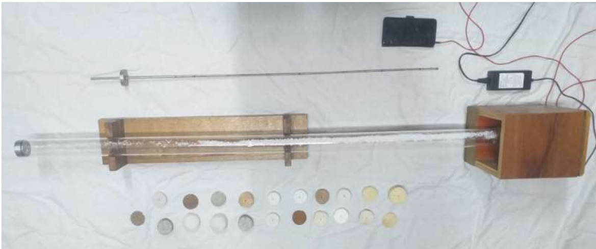
Figura 2.4: Tubo de Kundt fabricado. Fuente: elaboración propia.
