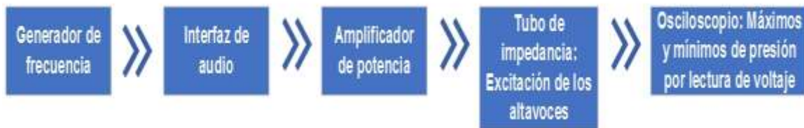
Figura 2.5: Diagrama de flujo-medición del coeficiente de absorción a incidencia normal.
