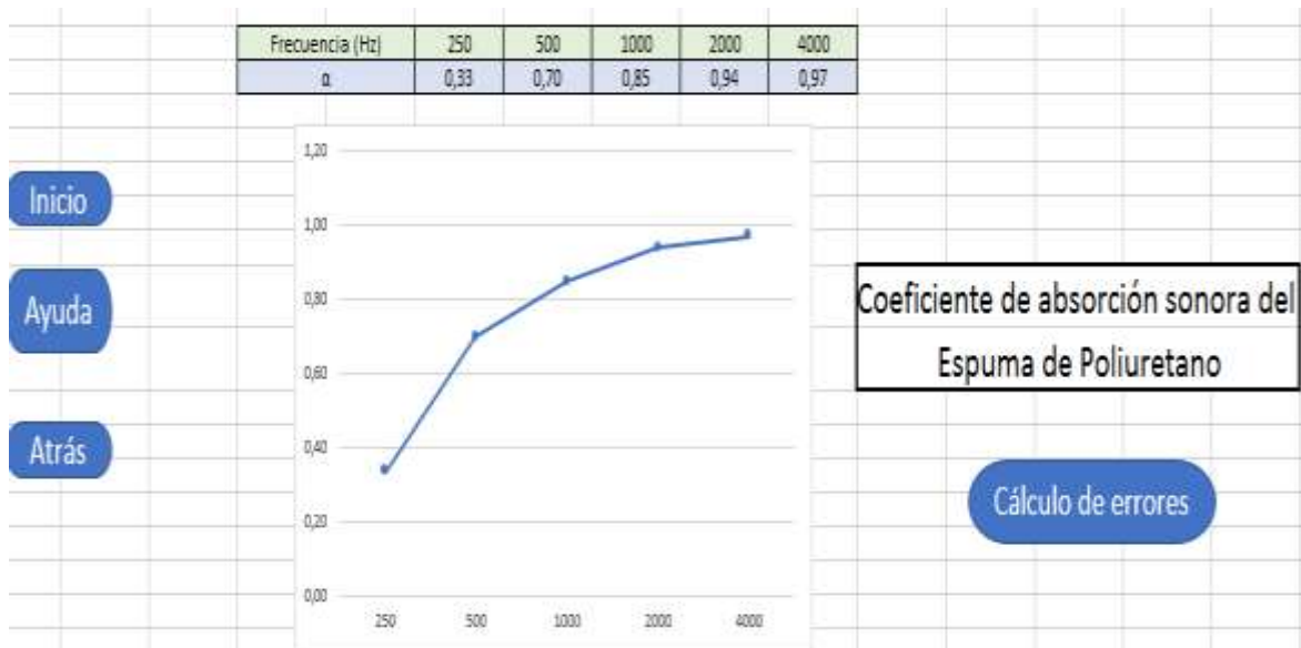
Figura 3.1: Coeficiente de absorción sonora en función de la frecuencia de la espuma de poliuretano de 5 cm de espesor.
