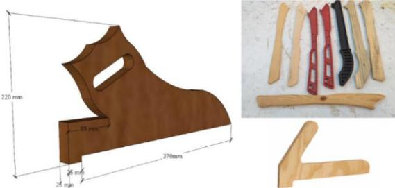
**Figura A2 Empujadores para el trabajo en sierra circular de mesa**
