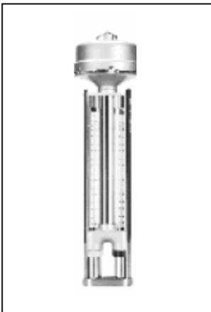
**Figura 2.2 Psicrómetro de aspiración**
