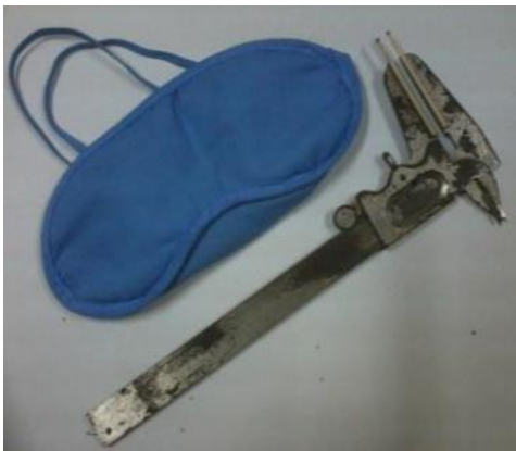
Figura 3.3. Foto del Pie de Rey y el limitador de visión.
