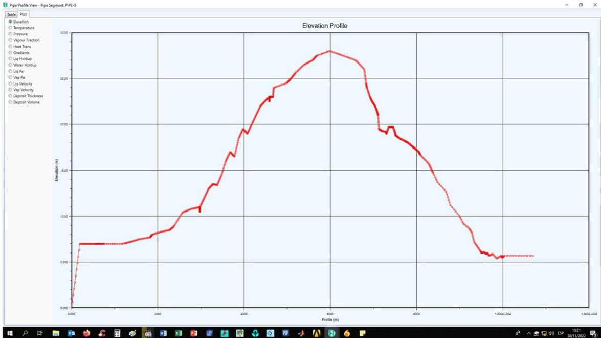
**Figura 3.1** Perfil topográfico desde la PPC hasta el punto de inyección de Cárdenas.
