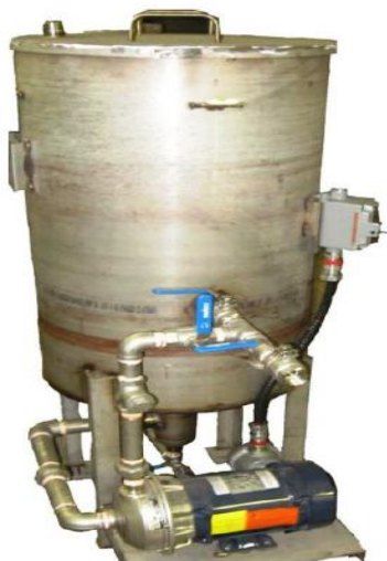
Figura 1.5. Separador de drenaje (HydrocarbonsProcesing, 2015)
