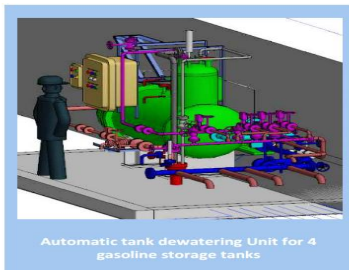
Figura 1.1. Sistema automático de drenaje de agua para tanques de gasolina. (LTD Intecha, 2013)
