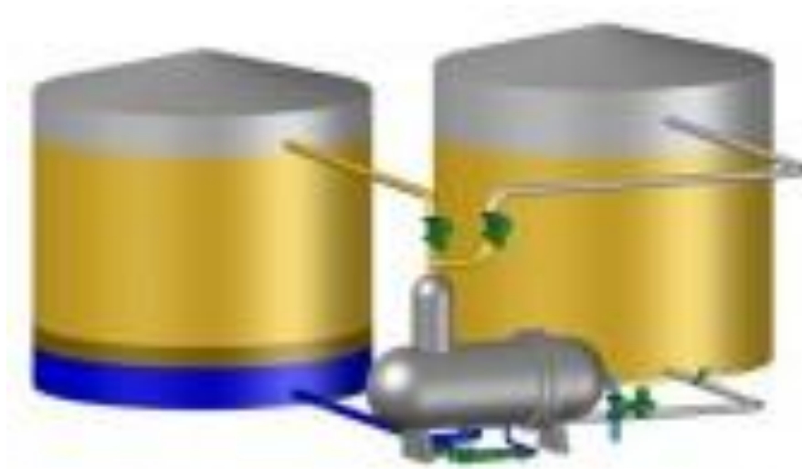
Figura 1.2. Sistema automático de drenaje de agua para tanques de gasolina. (Agar Corporation, 2015).
