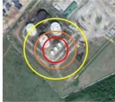
Figura 3.5: Alcance del escenario del charco de fuego ( Pool Fire ) en el tanque 703.
