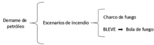
Figura 3.4: Posibles escenarios de incendio y explosión a partir de un derrame de petróleo.
