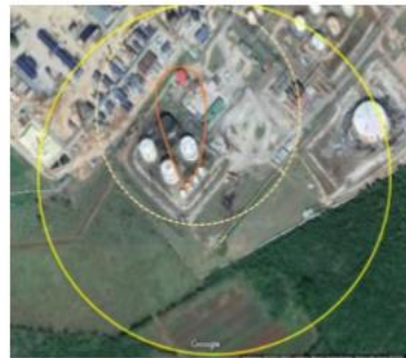
Figura 3.6: Alcance de una nube de vapor explosiva con respecto al tanque 703 de nafta.
