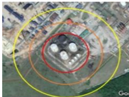
Figura 3.4: Alcance del escenario del charco de fuego (Pool Fire) en el tanque 103
