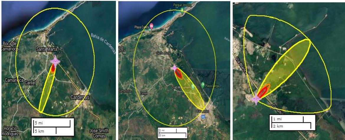
**Figura 3.11a:** Alcance del escenario nube tóxica en el tanque 6. **Figura 3.11b:** Alcance del escenario nube tóxica en el tanque 15. **Figura 3.11c:** Alcance del escenario nube tóxica en la bala 2.
