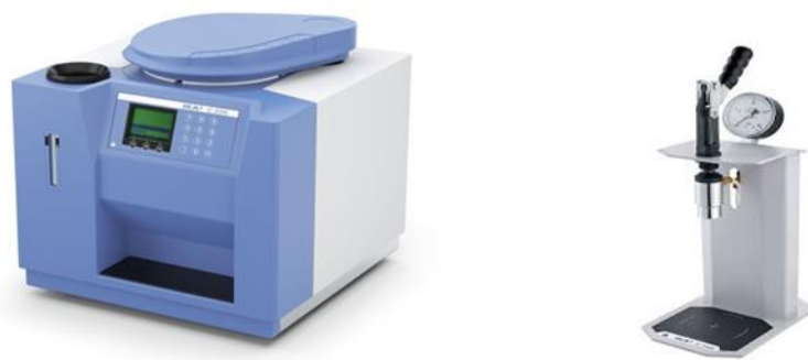
Figura 2.1: Calorímetro C-200 y Estación de oxígeno C-248.
