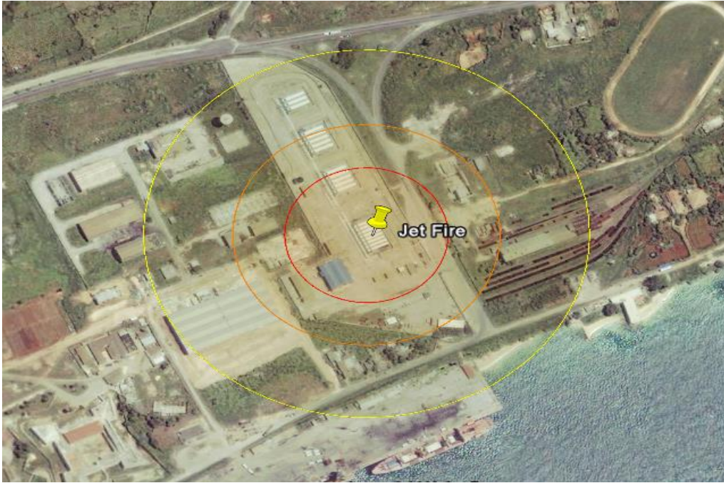
Figura 3.2: Alcance de las radiaciones de un Jet Fire en una bala de 200 m 3 .
