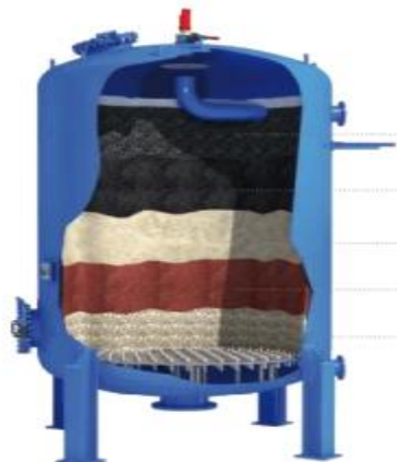
Figura 1.1: Filtro de arena con múltiples tipos de arena (STF, 2017).
