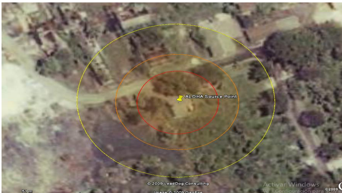
Figura 3.2: Comportamiento de la radiación originada por un pool fire para el Disulfuro de carbono.
