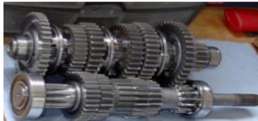
*Figura 1.1 Imagen interna de una caja de Cambios. (Cruz Crespo et al., 2021)*
