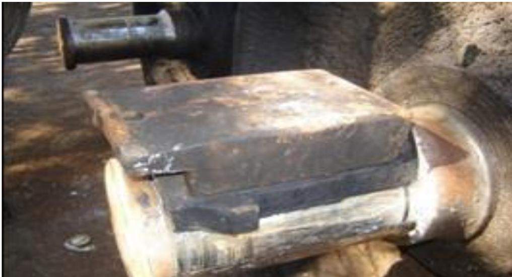
*Figura 1.3 Elementos del cojinete de deslizamiento*
