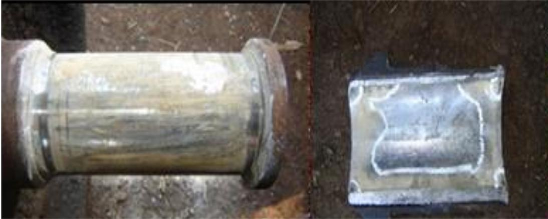
*Figura 1.5 Extremo del eje o muñón (izquierda) y superficie interior de la teja (derecha).*
