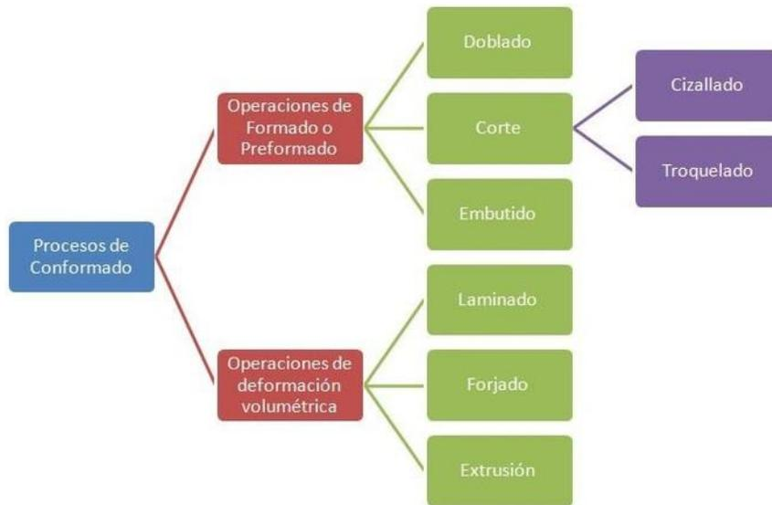
*Figura 1.8 Procesos de conformado.*
