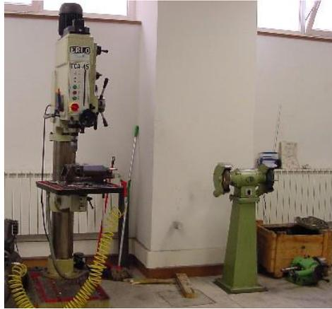
*Figura 1.14 Taladradora de columna y amoladora manual.*
