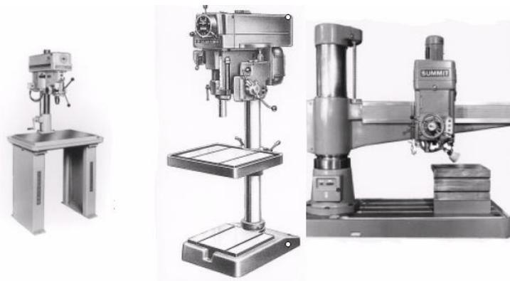
*Figura 1.13 Taladradora de banco, taladradora de columna y taladradora radial.*
