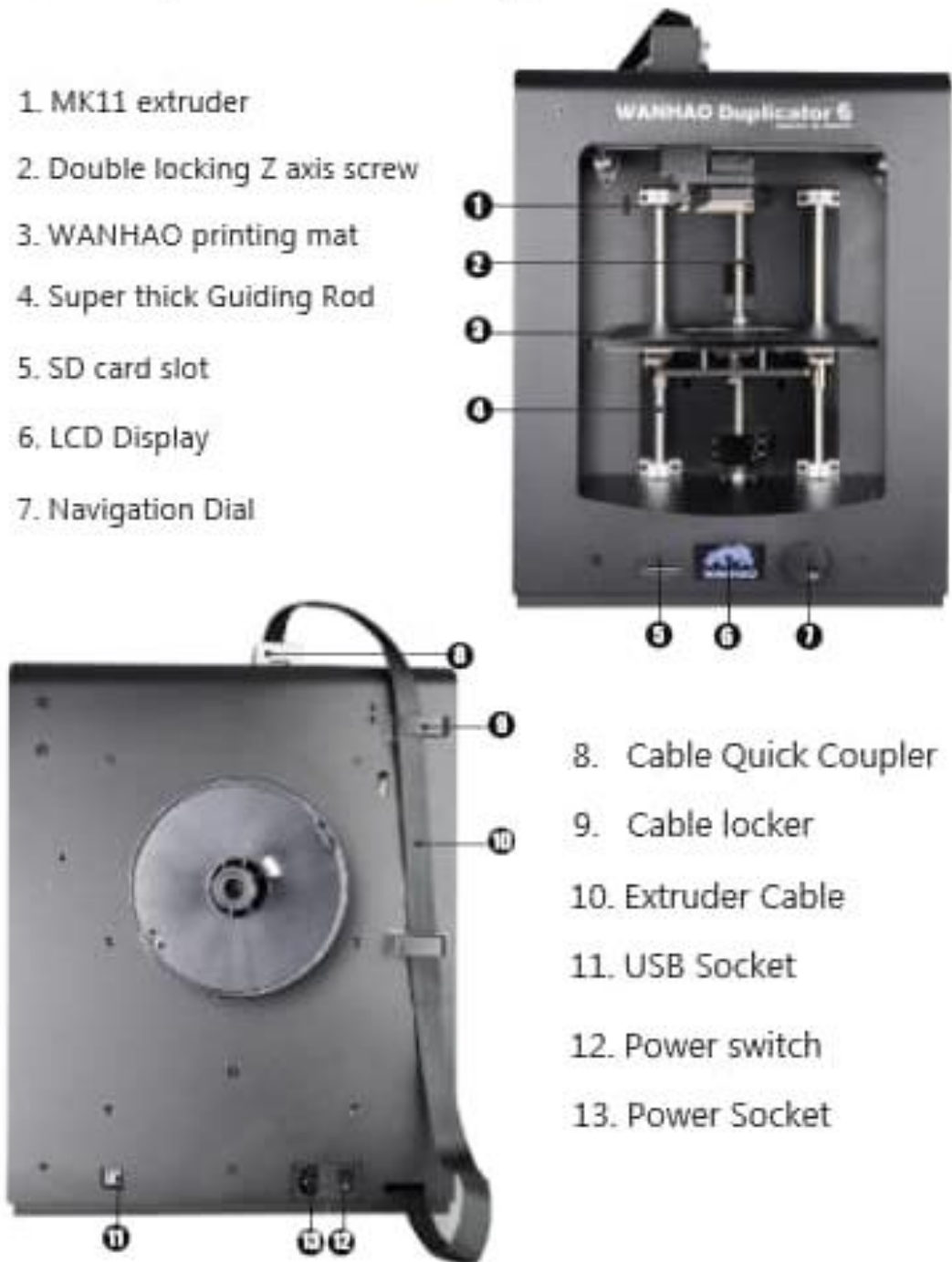
Foto 18 Partes de la impresora WANHAO Duplicator 6. Tomada de (Wanhao, WANHAO D6, 2020)
