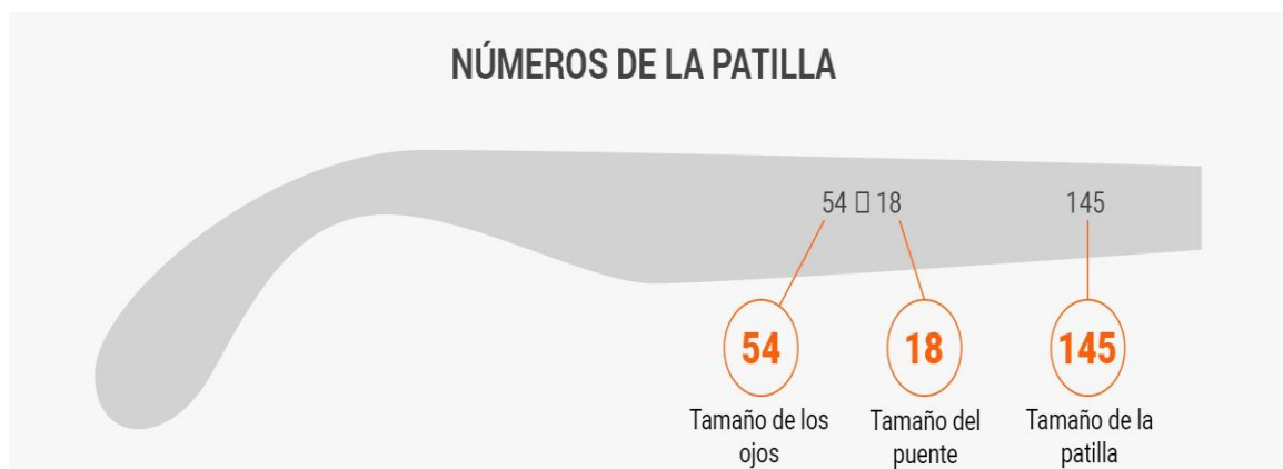
Figura 2. Medidas que se suele colocar en las patillas haciendo referencia a ciertos calibres de la armadura. Imagen tomada de (Letiamo, n.d.)
