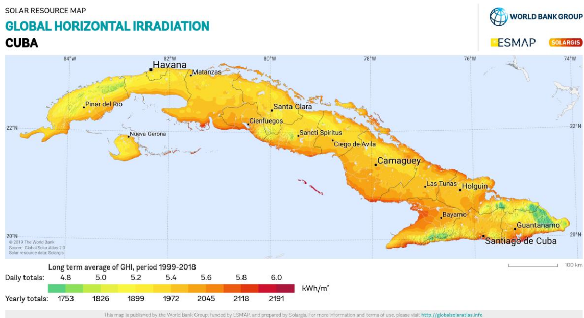
Figura 1.3 Distribución promedio anual y diaria de la radiación solar en Cuba. Fuente: Global solar atlas 2.0
