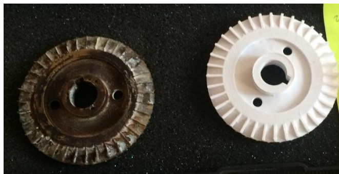
Figura 8: Comparación de la pieza real desgastada y el primer modelo impreso
