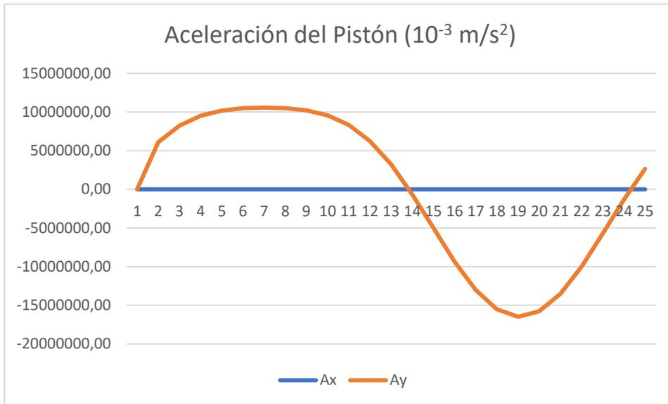
Figura 3.23 Grafica de Aceleración del Pistón a 5200 rpm
