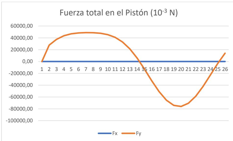
Figura 3.36 Grafica de Fuerza Total en el Pistón a 600 rpm
