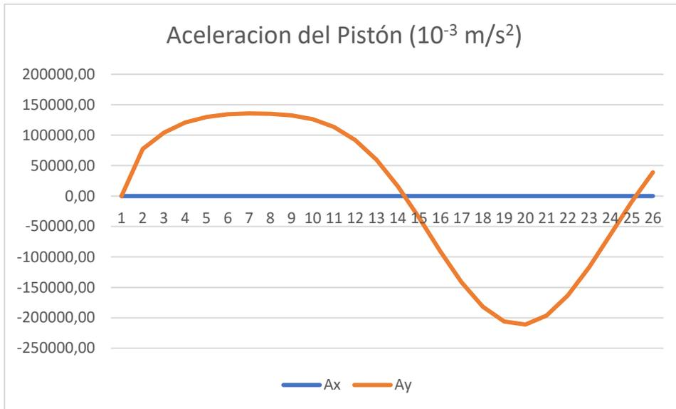
Figura 3.35 Grafica de Aceleración del Pistón a 600 rpm
