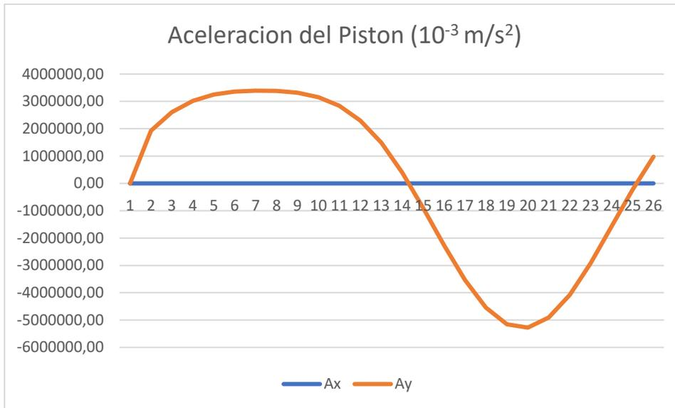
Figura 3.29 Grafica de Aceleración del Pistón a 3000 rpm
