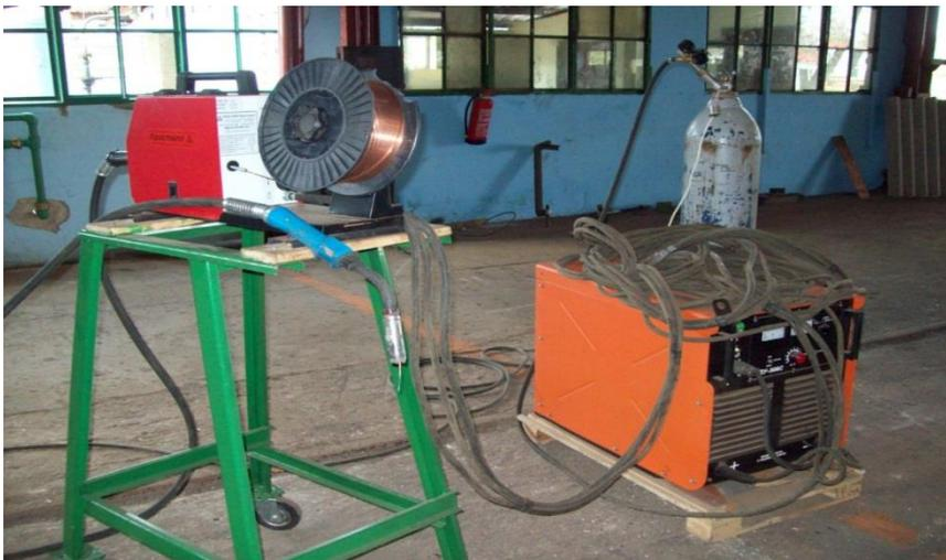
**Figura 2.2: Transformador BDY-506C Y3 con el cual se realiza el proceso de soldadura MIG - MAG.**
