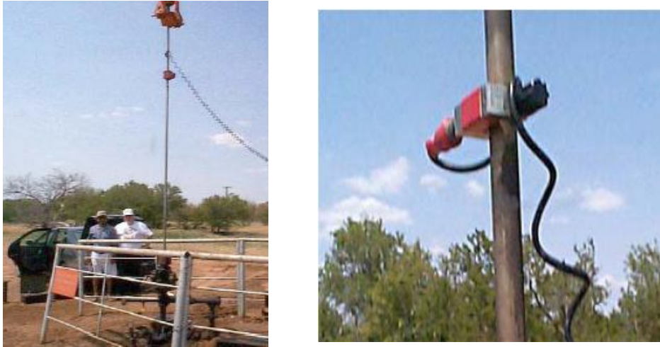
Fig 2.2 Colocación de la celda de carga. Fuente: TWM Echometer CO.
