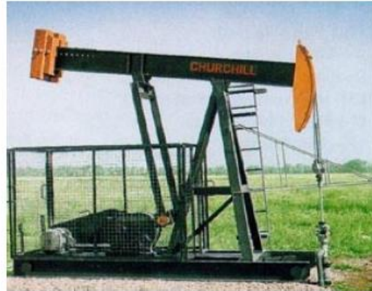
Fig.1.1 Unidad balanceada con brazo de contrapeso. Fuente: "Manual de bombeo mecánico UPCO de Venezuela S.A"
