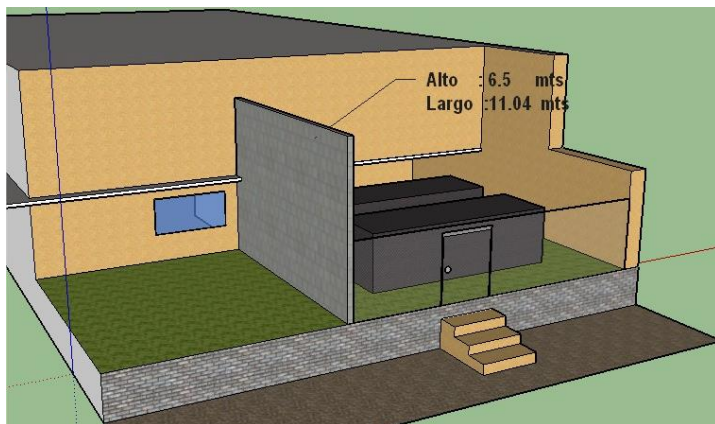
Figura 14.2. Simulación de la barrera en vista lateral derecha a través del software SketchUp.
