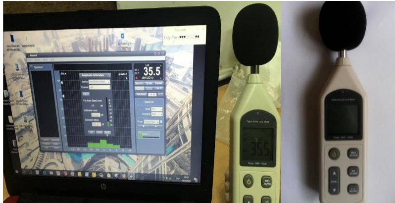
Figura 2.2. Sonómetro GK: 1290563 vinculado al software Smaart 7.
