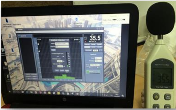
Figura 2.2. Sonómetro GK: 1290563 vinculado al software Smart 7.
