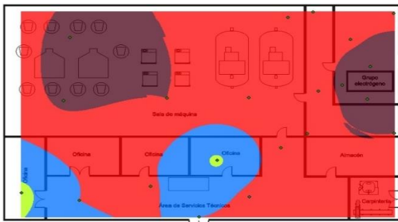
Figura 2.4. Ejemplo de un mapa de ruido del área de servicios técnicos de una instalación hotelera.
