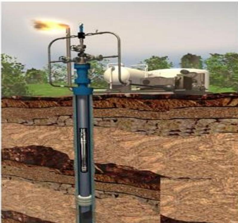
Anexo 15. Completación de producción con Bombeo Rotatorio de Cavidad Progressiva.
