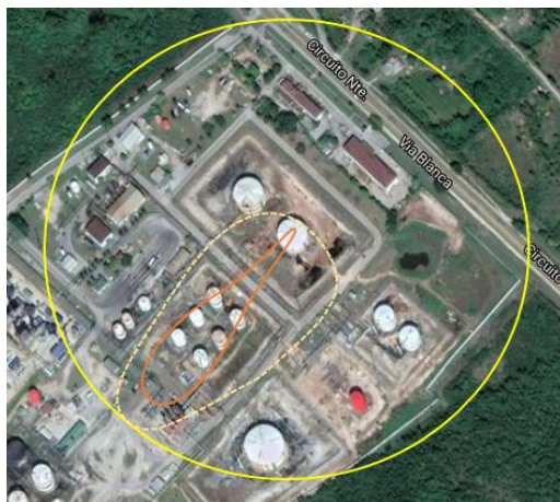
Figura 3.13 Alcance del accidente de explosión de una VCE en tanque 8
