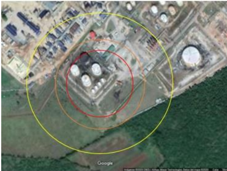
Anexo 26: Alcance del accidente por charco de fuego del tanque 702.
