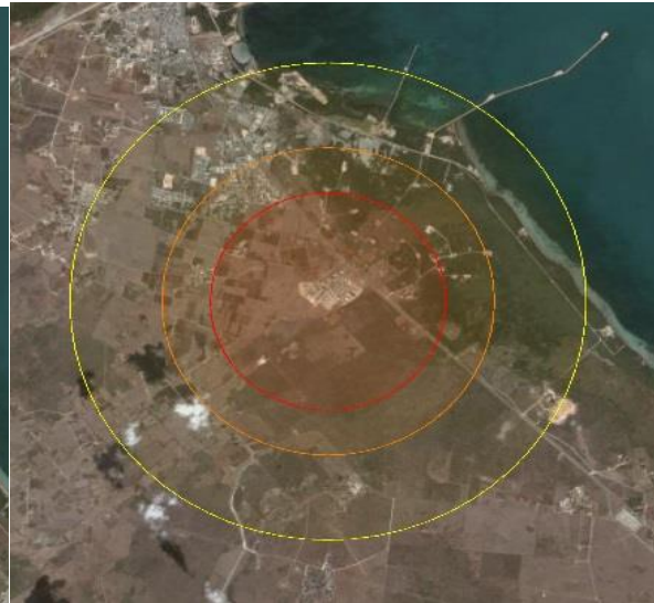
Figura 3.15b Alcance del accidente de BLEVE más bola de fuego en el tanque 101.
