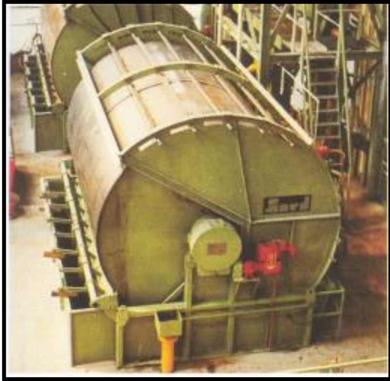
Figura 1.1: Filtro rotatorio de lodos moderno (Fuente: Rein, 2012)
