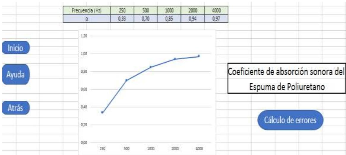
**Figura 3.1.** Coeficiente de absorción sonora en función de la frecuencia de la espuma de poliuretano de 5 cm de espesor. Fuente: elaboración propia.
