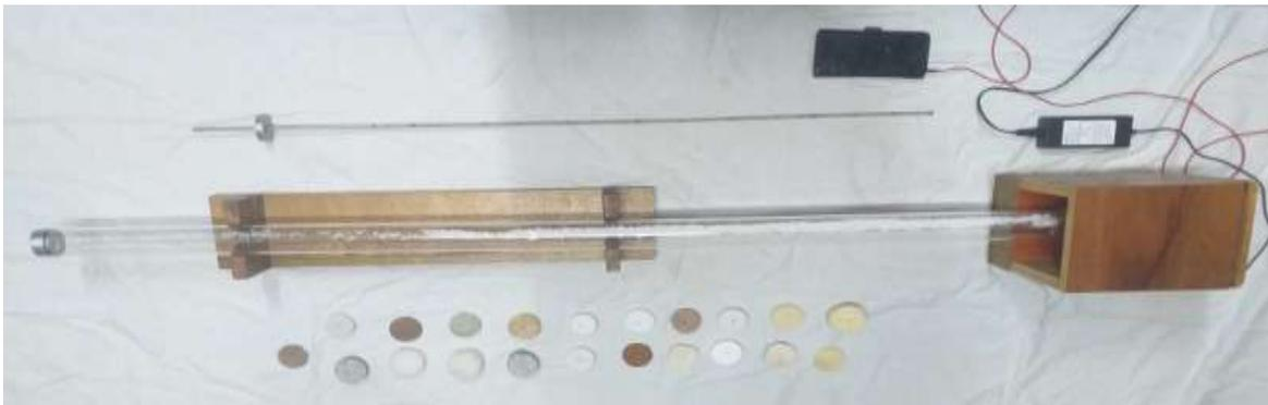
**Figura 2.4.** Tubo de Kundt fabricado. Fuente: elaboración propia.
