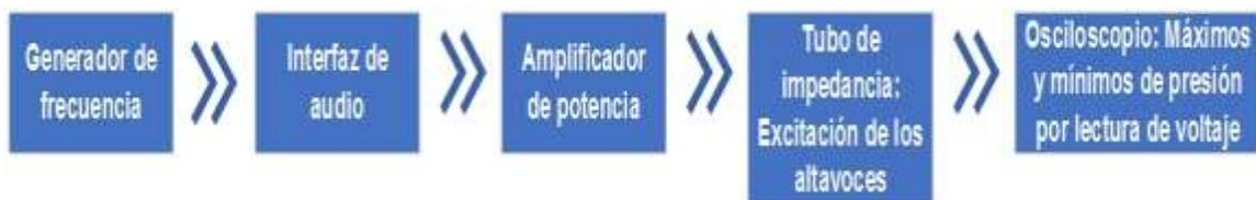
**Figura 2.5.** Diagrama de bloques de la configuración de los equipos usados para la medición del coeficiente de absorción a incidencia normal.
