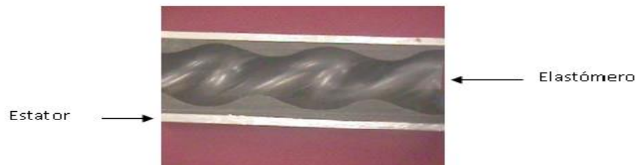
Figura 1.7 Corte longitudinal de un estator
