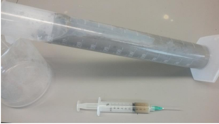
Figura 3.4: Vista superior de la probeta después de extraída el agua libre
