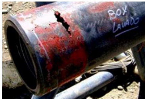
Figura 1.3. Drill collar averiado por vibraciones
