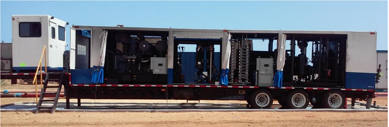
Figura A1.4 Unidad de generación de nitrógeno
