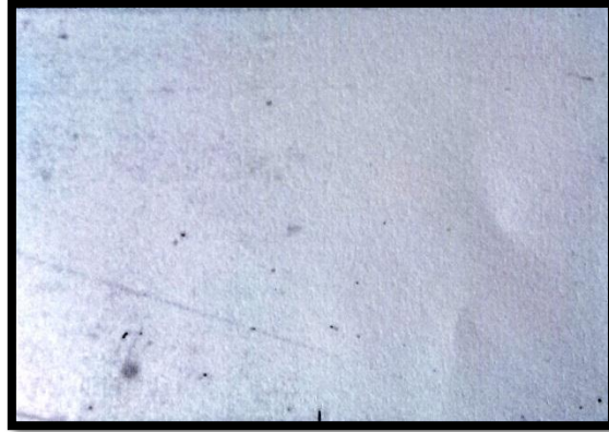
Figura 3.19: Inclusiones No Metálicas del Tipo D. Observación a 100x.
