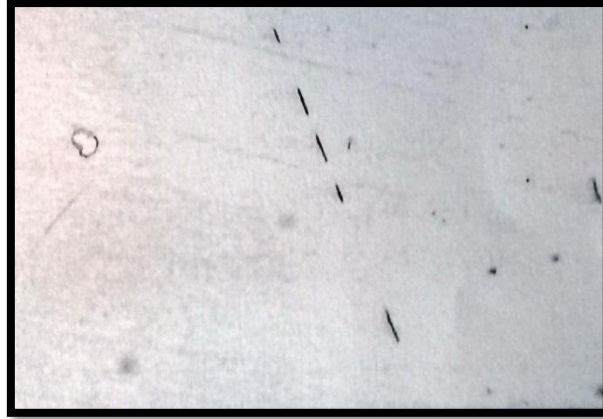
Figura 3.25: Posible Microgrieta. Observación a 100x.
