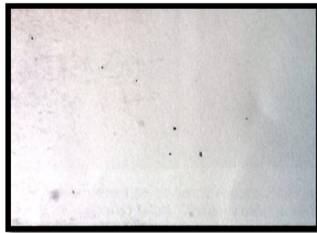
Figura 3.4: Inclusiones No Metálicas del Tipo D (óxidos globulares). Observaciones a 100x.
