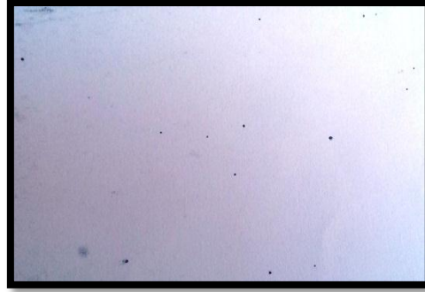
Figura 3.28: Inclusiones no metálicas del tipo D. Observación a 100x.
