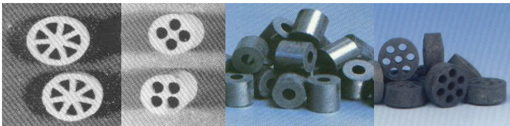
Figura 2: Catalizadores que se utilizan en la producción de hidrógeno
