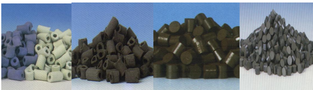
Figura 2: Catalizadores que se utilizan en la producción de hidrógeno
