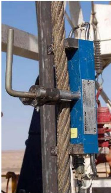
Figura 1.7. Sensor de cargas. Fuente: Tviedal, T., 2011
