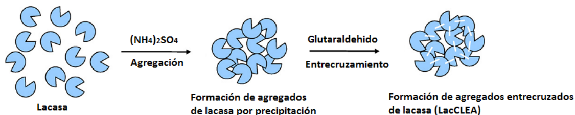
Figura 4. Obtención del biocatalizador de lacasa de Trametes versicolor por formación de agregados entrecruzados (Lac-CLEA).
