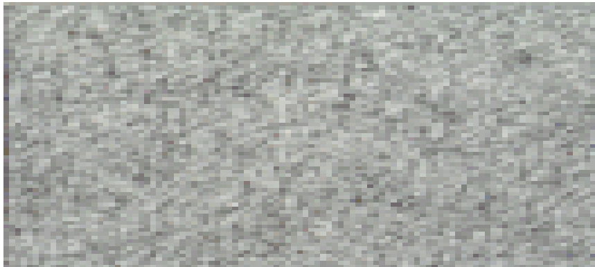
Figura 4: Preparación Superficial de Sa 2 1/2 .
