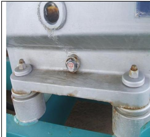
Figura 2.27 Soportes del motor.
