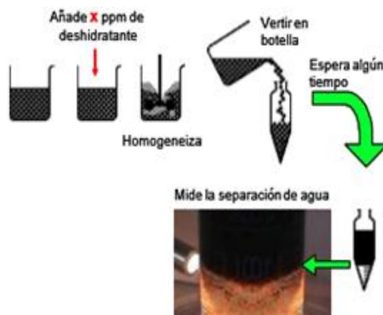
*Figura 1.10 Procedimiento para la realización de la Prueba de Botella*
