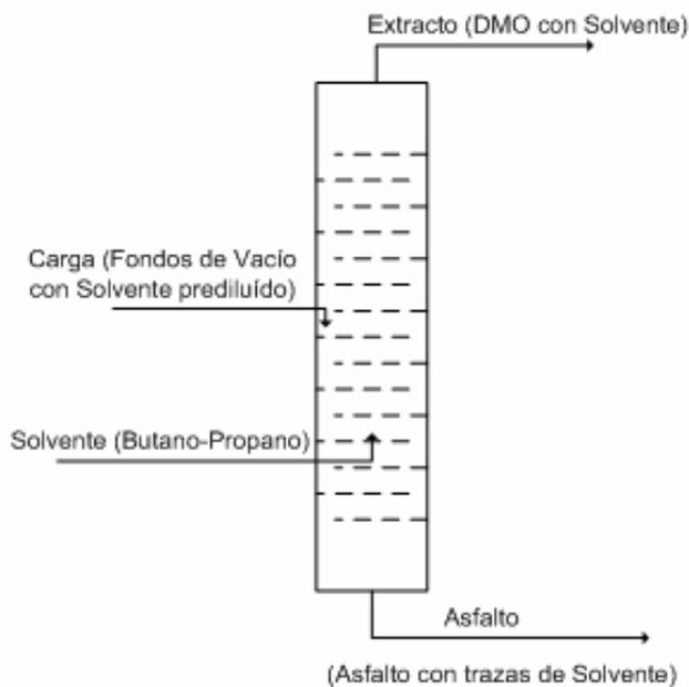
Figura 1.1.Extracción líquido-líquido en torres desasfaltadotas.
