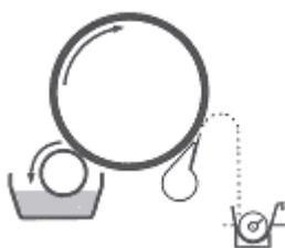
Figura 1: Secador de tambor simple con rodillo aplicador propuesto por Simón (2010) para el secado de cola animal.
