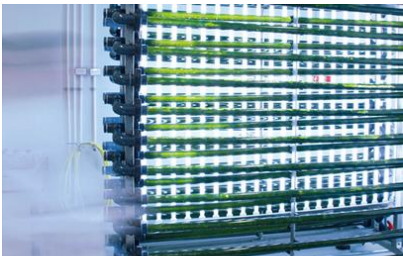
Anexo 7: Fotobiorreactor tubular.
